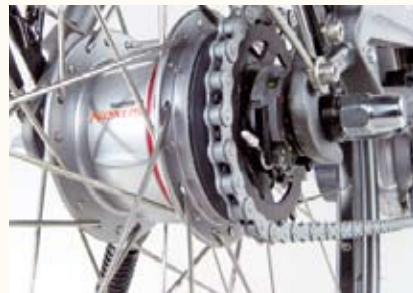
Starke Kombination: Shimano 8-fach Nabenschaltung inklusive Rücktrittbremse, dazu Antirost-behandelte Kette. Die sollten alle Cityräder haben! Unten: Rahmendetail für beste Stabilität ohne Flattern; interne Kabelverlegung
